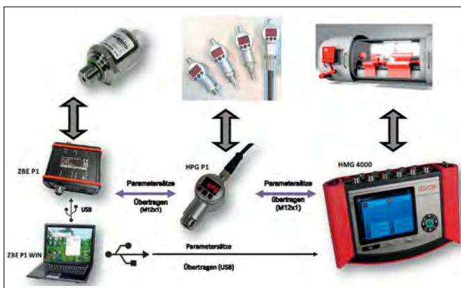
Parametrier- und Datenübertragungsmöglichkeiten bei Hydac IO-Link-Sensoren unabhängig vom IO-Link-System; Quelle: Hydac Electronic
